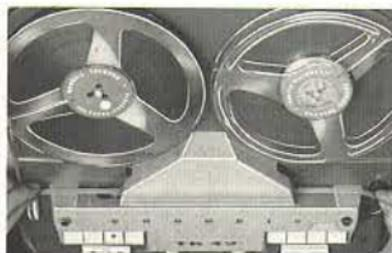
Die Schwungscheiben werden jetzt alle mit einem Farbüberzug versehen. Ungespritzte Schwungscheiben sollten beim Service nachgesehen werden, damit die Lauffläche stets sauber ist. Eventuelle Reinigung erfolgt mit Reiniger 10007 (Testbenzin). Danach ist das Gerät gut abblüffen zu lassen.
