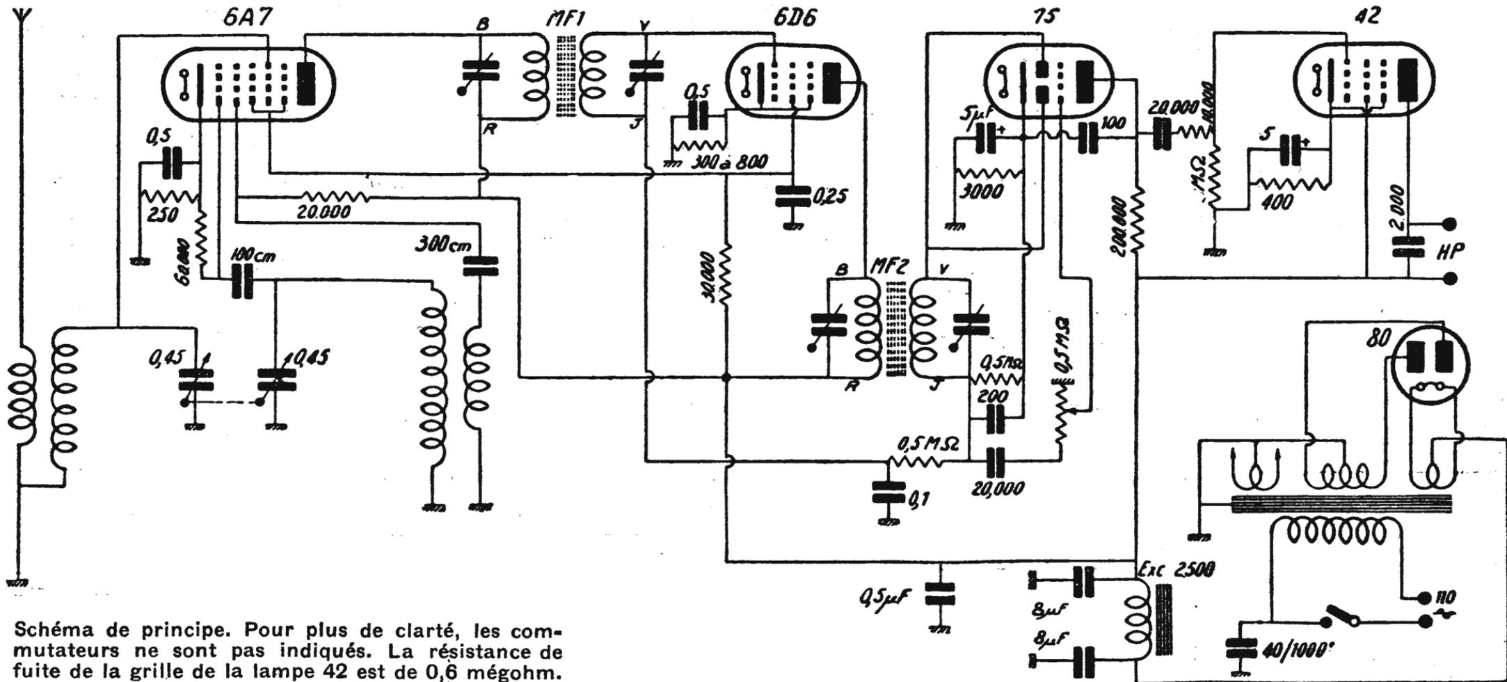
Schéma de principe. Pour plus de clarté, les commutateurs ne sont pas indiqués. La résistance de fuite de la grille de la lampe 42 est de 0,6 mégohm.
