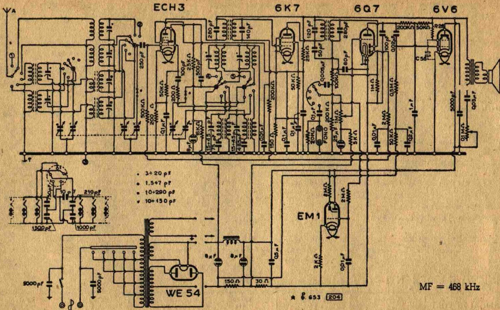
Su questo schema si hanno due varianti: "1341", senza dispositivo di sintonia automatica e "1343", radiofonografo in cui la 6V6 è sostituita dalla 6L6 con l'aggiunta di R28 = 5000Ω e C56 = 0,1 μF.
