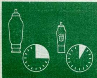
Consommation comparée : à gauche une lampe ancienne (2,6 watts) à droite une Miniwatt rouge (1,26 w.)
