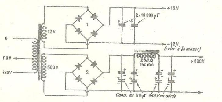
4. — Schéma de principe de l'alimentation du BC 604 : 1 = redresseur au sélénium 12 V - 5 A (minimum); 2 = pont réalisé avec 4 diodes BYX 10
