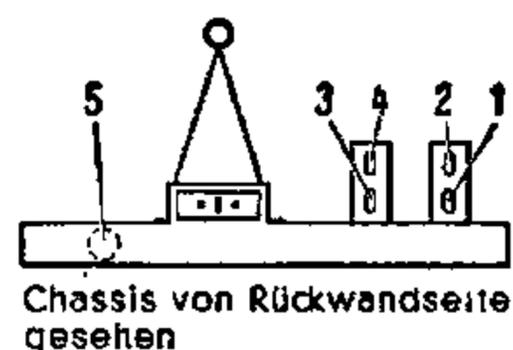
ZF-Saugkreis (460 kHz): Ein Nachgleich ist äußerst selten erforderlich. Bei Abgleich: Meßsender (460 kHz) an Antennenbuchse über Ersatzantenne (400  $\Omega$  in Reihe 200 pF) anschließen und Spule (5) auf Tonminimum abgleichen.
