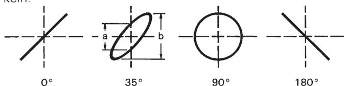
Die Berechnung des Phasenwinkels oder der Phasenverschiebung zwischen den X- und Y-Eingangsspannungen (nach Messung der Strecken **a** und **b** am Bildschirm) ist mit den folgenden Formeln und einem Taschenrechner mit Winkelfunktionen ganz einfach und übrigens **unabhängig von den Ablenkamplituden** auf dem Bildschirm.
