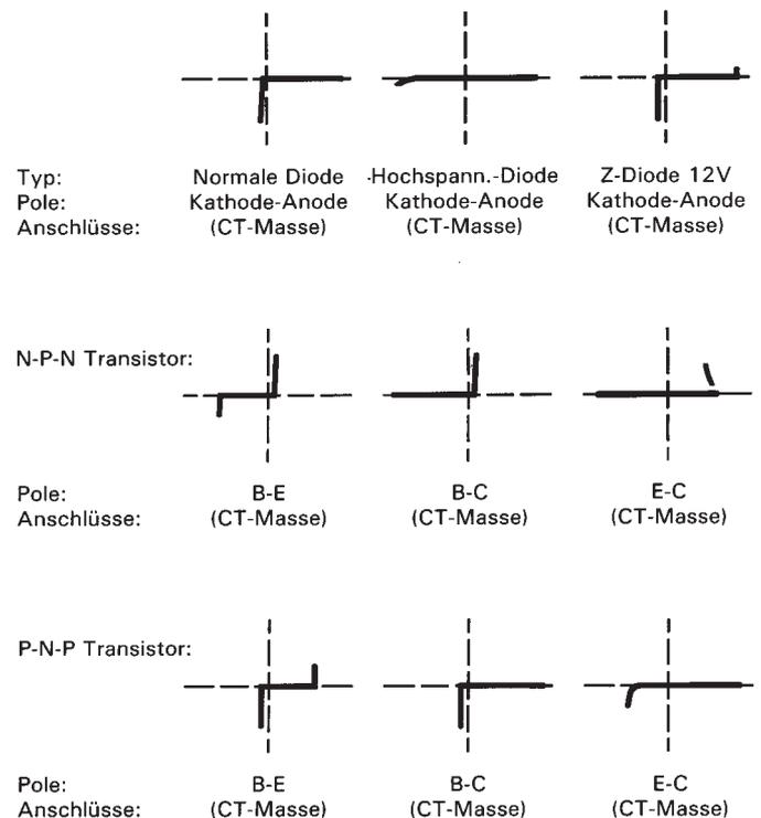
Wichtiger noch ist die einfache Gut-Schlecht-Aussage über Bauteile mit Unterbrechung oder Kurzschluß, die im Service-Betrieb erfahrungsgemäß am häufigsten benötigt wird.
