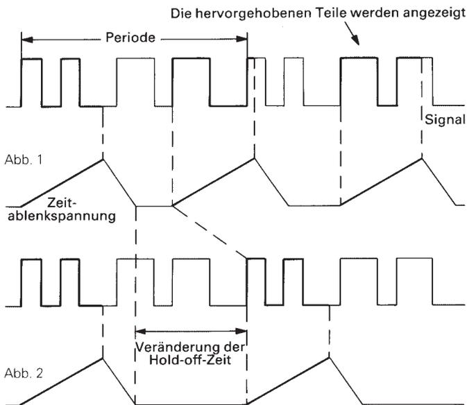
Abb. 1 zeigt das Schirmbild bei Rechtsanschlag des **HOLD-OFF**-Einstellknopfes (Grundstellung). Da verschiedene Teile des Kurvenzuges angezeigt werden, wird kein stehendes Bild dargestellt (Doppelschreiben).
