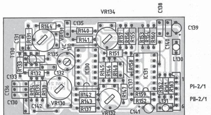
**Y-Zwischenverstärker Kanal I und II, Kanal Flip-Flop,
