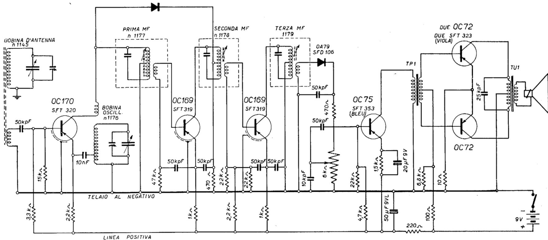
Fig. 13.8. - Schema del tascabile a 6 transistor e 2 diodi Geloso mod. Polaris G 3303.
