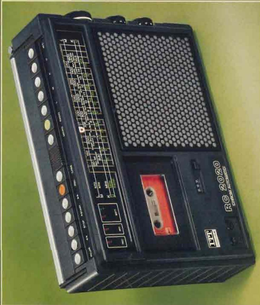
Bemerkenswert ist an diesem Gerät die elektronische Funktionsanzeige durch Leuchtdioden für Senderabstimmung (Leuchtdiode im Skalenzeiger leuchtet auf bei optimal eingestelltem Sender), Cassetten-Aufnahme, Mikrofon-Aufnahme, Batteriekontrolle (zweifach: Batteriespannung reicht aus bzw. Batterie muß ausgetauscht werden).
