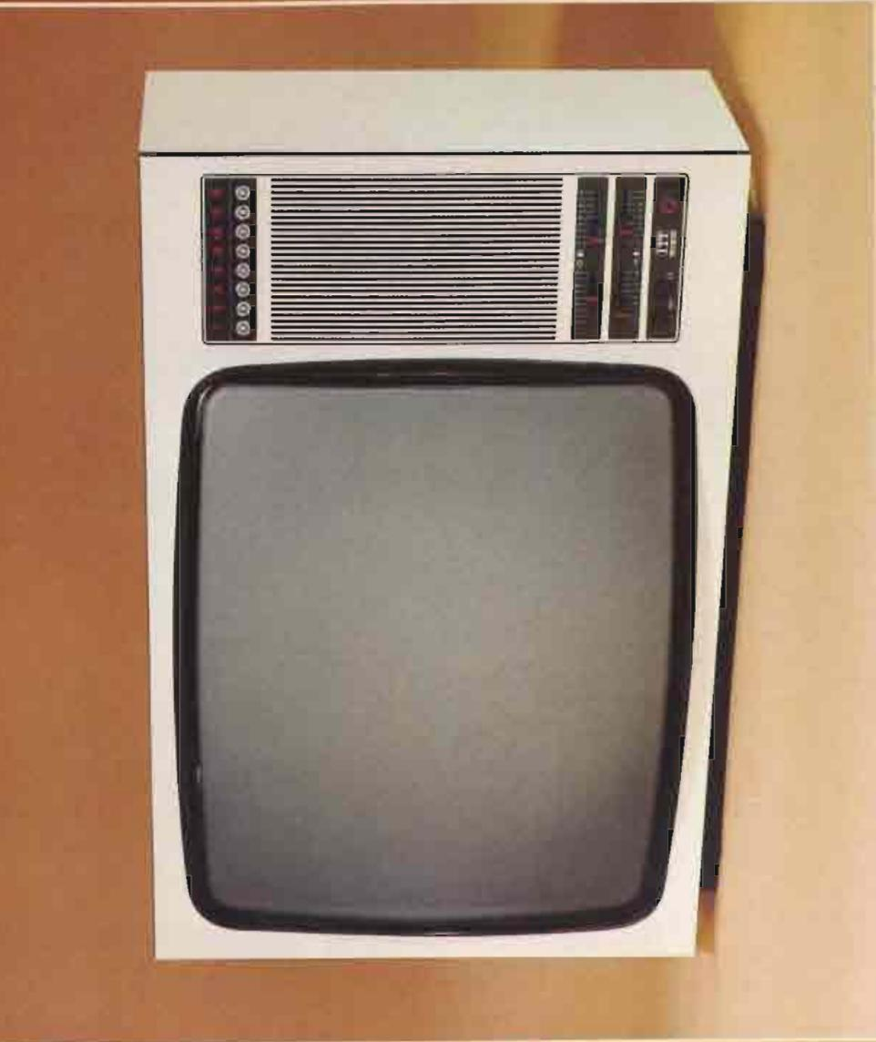
Das Komfortmodell unter den Schwarzweiß-Geräten. Programmierung über voll elektronischen TV-Sensor oder durch die manuelle – als Zubehör lieferbare – Fernbedienung FB 1300 electronic. Einstellungsmöglichkeiten: Bildhelligkeit und Lautstärke.
