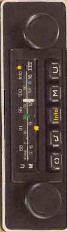
einen. So sorgt der integrierte Stereo-Decoder mit automatischem Mono-Stereo-Schalter für einwandfreien UKW-Stereo-Empfang. Bei gedrückter „Info“-Taste stoppt der Selectronic-Suchlauf nur auf Verkehrswarfunf-Sendern.
