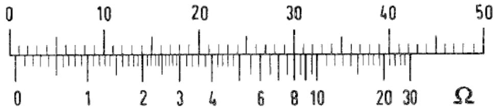
Noterete che al centro scala si leggono solo 5 Ohms e cioè la decima parte della scala normale con portata diretta Ohms x 1.
