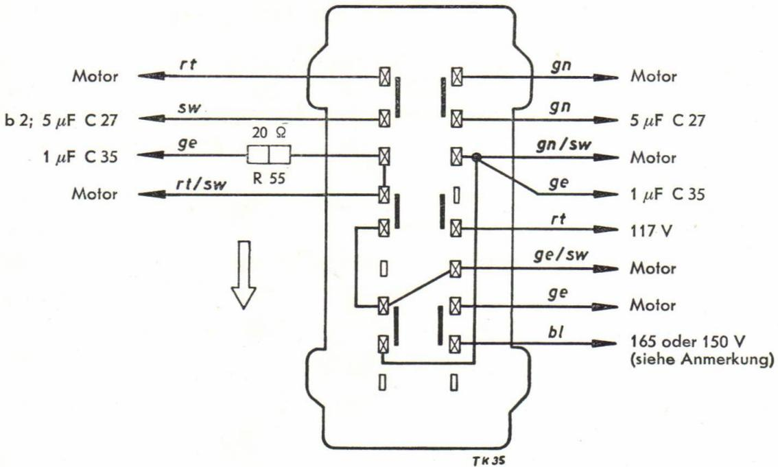
Bei manchen Geräten zeigt sich starker Ölaustritt aus dem Motor infolge Erwärmung. Beim Service empfiehlt es sich deshalb, Motoren mit der Papstbezeichnung KLM 20.65 — 4 / 8 — **370 D** auf die 150-V-Anzapfung des Netztrafos zu schalten.
