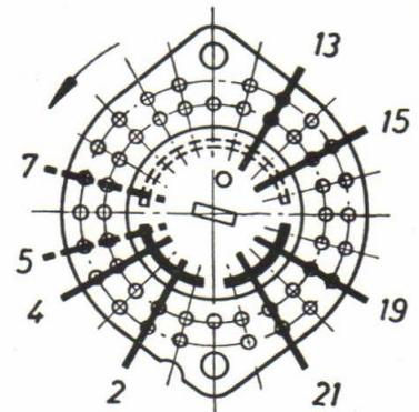
Die Kontakte 5/7 schließen während des Umschaltens die NF kurz. Schaltwinkel  $180^\circ$  in Pfeilrichtung.
