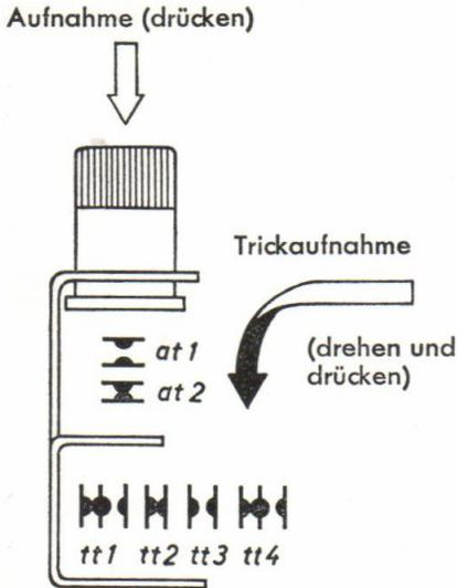
Die tt-Kontakte werden durch Drehen, die at-Kontakte durch Drücken betätigt.
