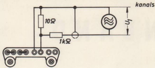
**Ms 2** zur Messung des Aufnahmestromes und der Vormagnetisierung
