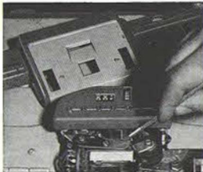
Zur Säuberung der Tonköpfe kann nach Abziehen des Schaltnebels für die Bandgeschwindigkeit die Abdeckplatte abgenommen werden. Dazu sind die beiden Befestigungsschrauben mit einer Münze o. ä. zu lösen. Vorher jedoch Taste „Halt“ drücken, Gerät ausschalten und Netzstecker ziehen!
