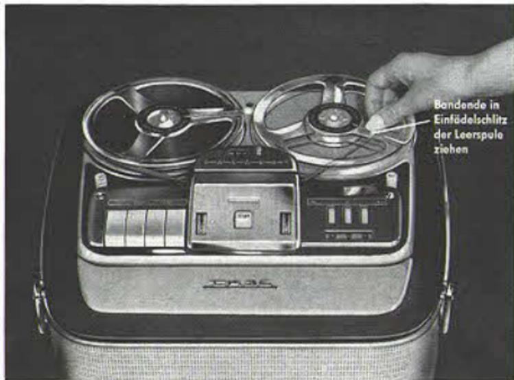
Das aus dem Spulenschlitz hervorragende Ende des grünen Vorspannbandes soll möglichst kurz sein (ca. 1 cm). Während es mit dem Finger leicht gegen die Spulenoberfläche gedrückt, also festgehalten wird, dreht man die Leerspule mit dem eingefädelten Band jetzt mit der Hand so weit, bis das Vorspannband und die Silberfolie (die zum späteren automatischen Abschalten dient) aufgewickelt ist. Hierdurch ist gleichzeitig für eine genügende Festlegung des Bandendes auf der Leerspule gesorgt.
