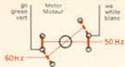
Blick von innen auf die Lötseite des Frequenzwählers. Interior view on soldering tags of frequency selector. Vue sur les soudures de sélecteur de fréquence
