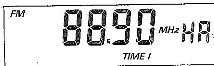
Per la ricezione delle Onde Corte, al posto della frequenza è possibile immettere direttamente le bande metriche da 11 a 90 (col Satellit international 400 anche la banda per amatori da 10 m).
