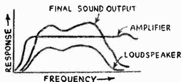
HOW STRAIGHT LINE AMPLIFIER INTENSIFIES LOUDSPEAKER CHARACTERISTICS
