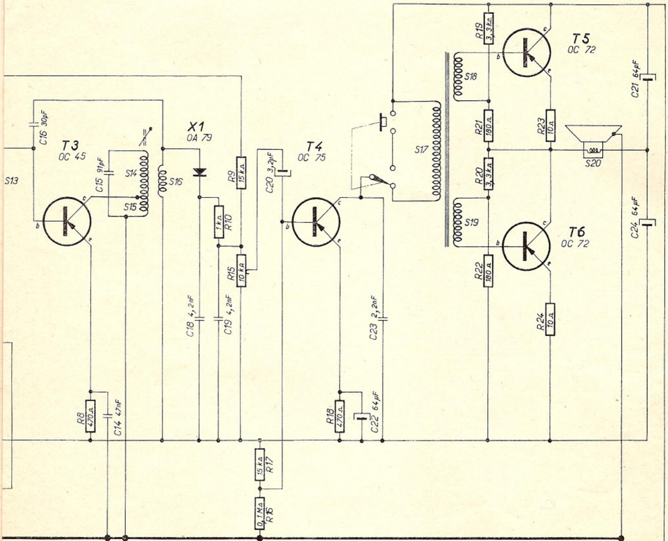
2. **Réglage des circuits H.F.** Coupler le générateur au cadre par une boucle de quelques spires.
