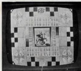
f) L'image ne couvre pas toute la largeur du tube : largeur d'image insuffisante.
