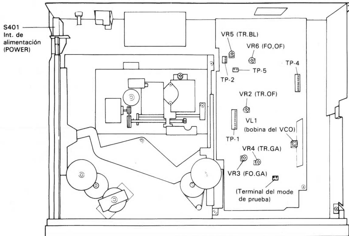
Fig. 10-1 Puntos de ajuste
