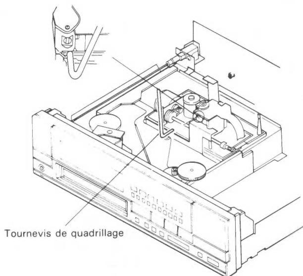
Fig. 10-3 Réglage de quadrillage
