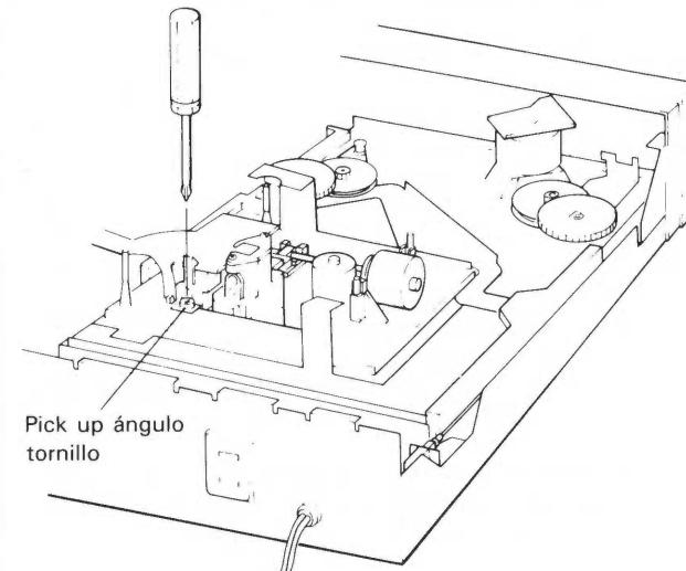
Fig. 10-5 Ajuste pick up ángulo
