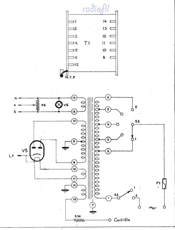
MILLIVOLTMETRE ÉLECTRONIQUE MOD.752 MÉTRIX ALIMENTATION
