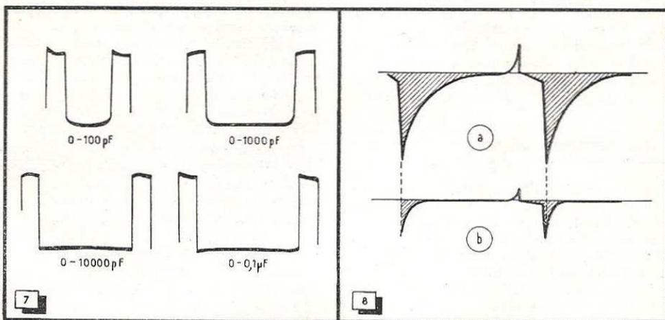
Fig. 7. — Oscillogrammes relevés sur le CM-1, entre masse et borne noire, pour chacune des quatre gammes. On a presque affaire à des impulsions parfaites.
