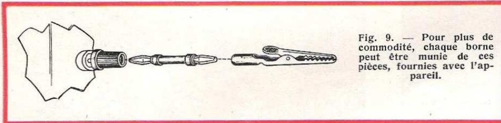
Fig. 9. — Pour plus de commodité, chaque borne peut être munie de ces pièces, fournies avec l'appareil.
