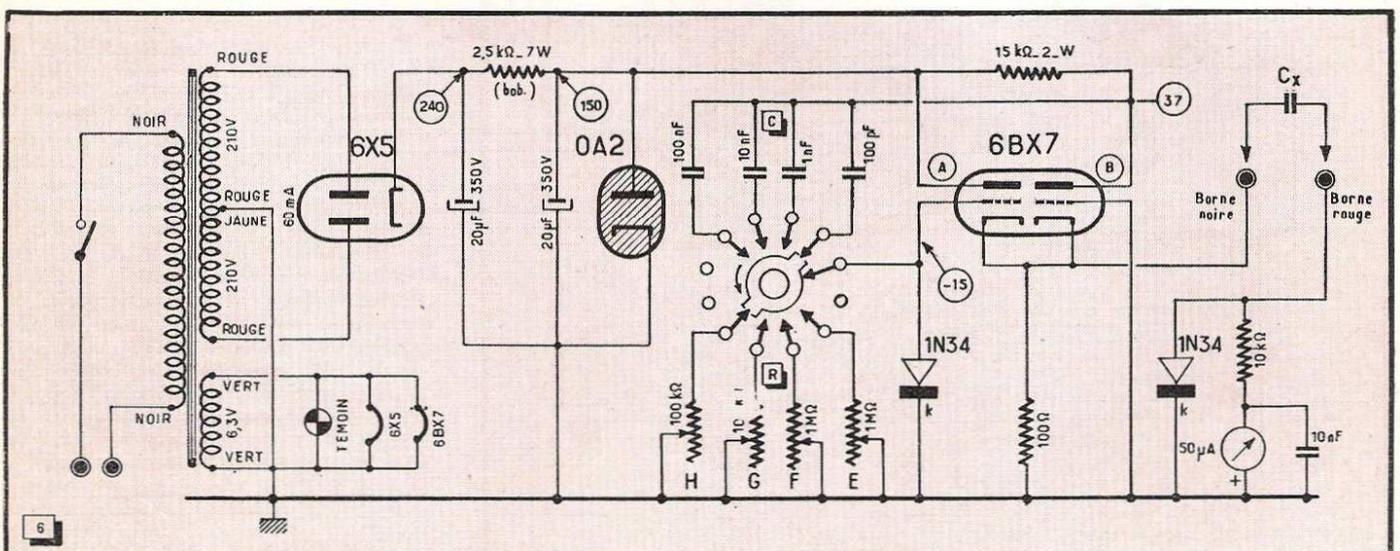
Fig. 6. — Schéma complet du capacimètre CM-1 Heathkit. Le contacteur de gammes est représenté sur la sensibilité 0-100 pF.
