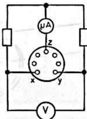
Meßbuchsen X, Y und Z, gemäß Schalt-skizze, anschließen.
