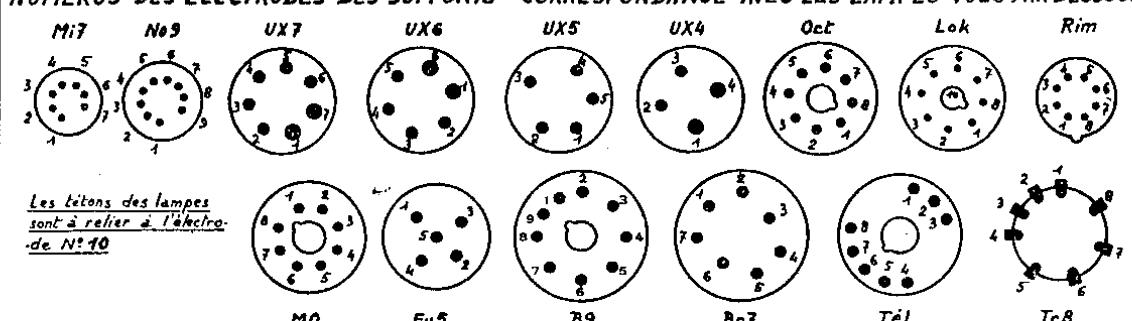
**NUMEROS DES ELECTRODES DES ADAPTATEURS - CORRESPONDANCE AVEC LES LAMPES VUES PAR DESSOUS**
