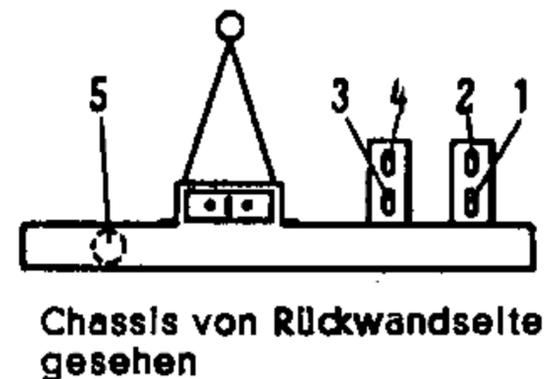
ZF-Saugkreis (460 kHz): Ein Nachgleich ist äußerst selten erforderlich. Bei Abgleich: Meßsender (460 kHz) an Antennenbuchse anschließen und Spule (5) auf Tonminimum abgleichen.
