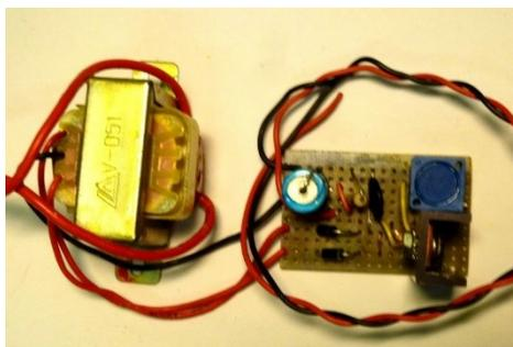
Figure 9 : L'alimentation basse-tension.
