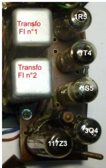
Figure 5 : Les 5 lampes et les transfos FI
