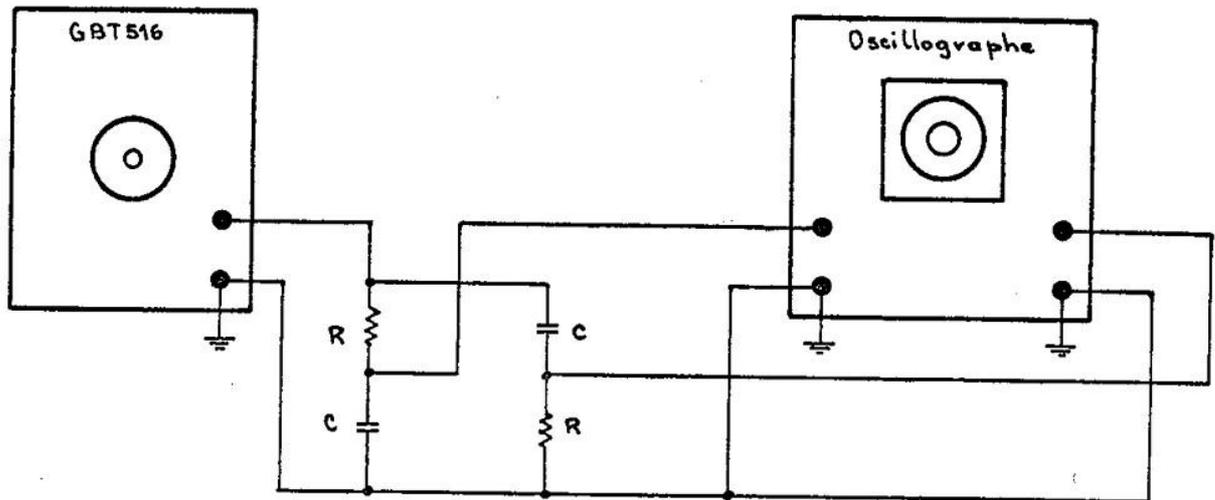
3.3.6. - Mesure de la surtension d'un bobinage
