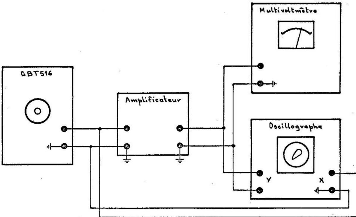
3.3.2. - Etalonnage de la base de temps d'un oscillographe cathodique
