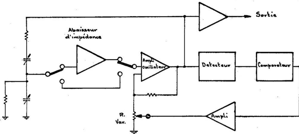
Le schéma synoptique ci-dessus aidera à la compréhension du fonctionnement de l'oscillateur.
