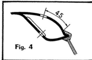
3° Repérer avec soin l'axe du pavillon, puis de l'extérieur, pointer et percer un trou de 10 mm.
