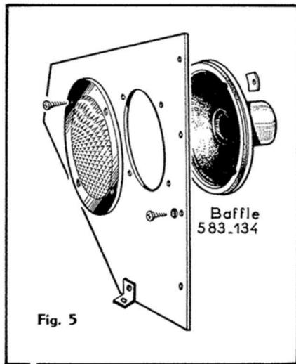
1° Assembler le H.P. et sa grille ainsi que l'équerre E sur le baffle fourni avec l'équipement, voir figure 5.
