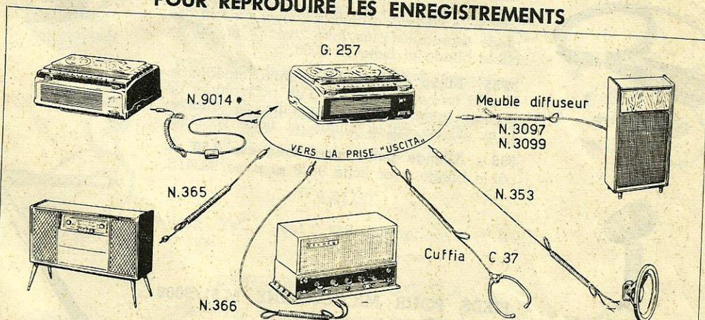
Pour la copie des enregistrements d'un magnétophone sur un autre, remplacer les pinces crocodiles du 9014 par une fiche 9008 et intercaler entre les 2 fils une résistance de 3 ohms 1 Watt, remplaçant la résistance de charge du haut-parleur. Comme haut-parleur extérieur, il est conseillé le SP 200/ST (diam. 20 cm), monté dans son baffle N. 3102 ou dans un autre meuble acoustique adéquat.
