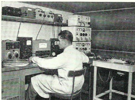
Mesure des propriétés magnétiques des oxydes avant le couchage.
