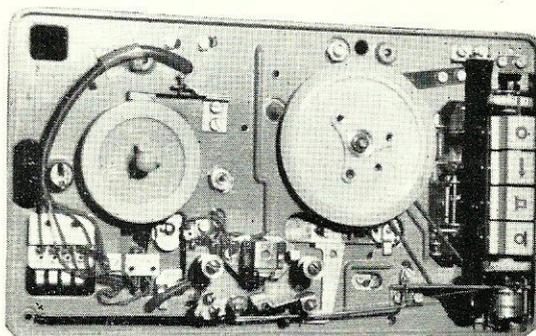
Montage électronique remarquablement bien conçu et très accessible rendant ainsi la panne éventuelle facilement décelable. Mécanique robuste malgré le faible poids de l'ensemble. Naturellement la qualité sonore entre peu en ligne de compte quand il s'agit d'une machine à dicter et ne peut être considérée dans le cas de la Sténorette B comme étant un point faible.
