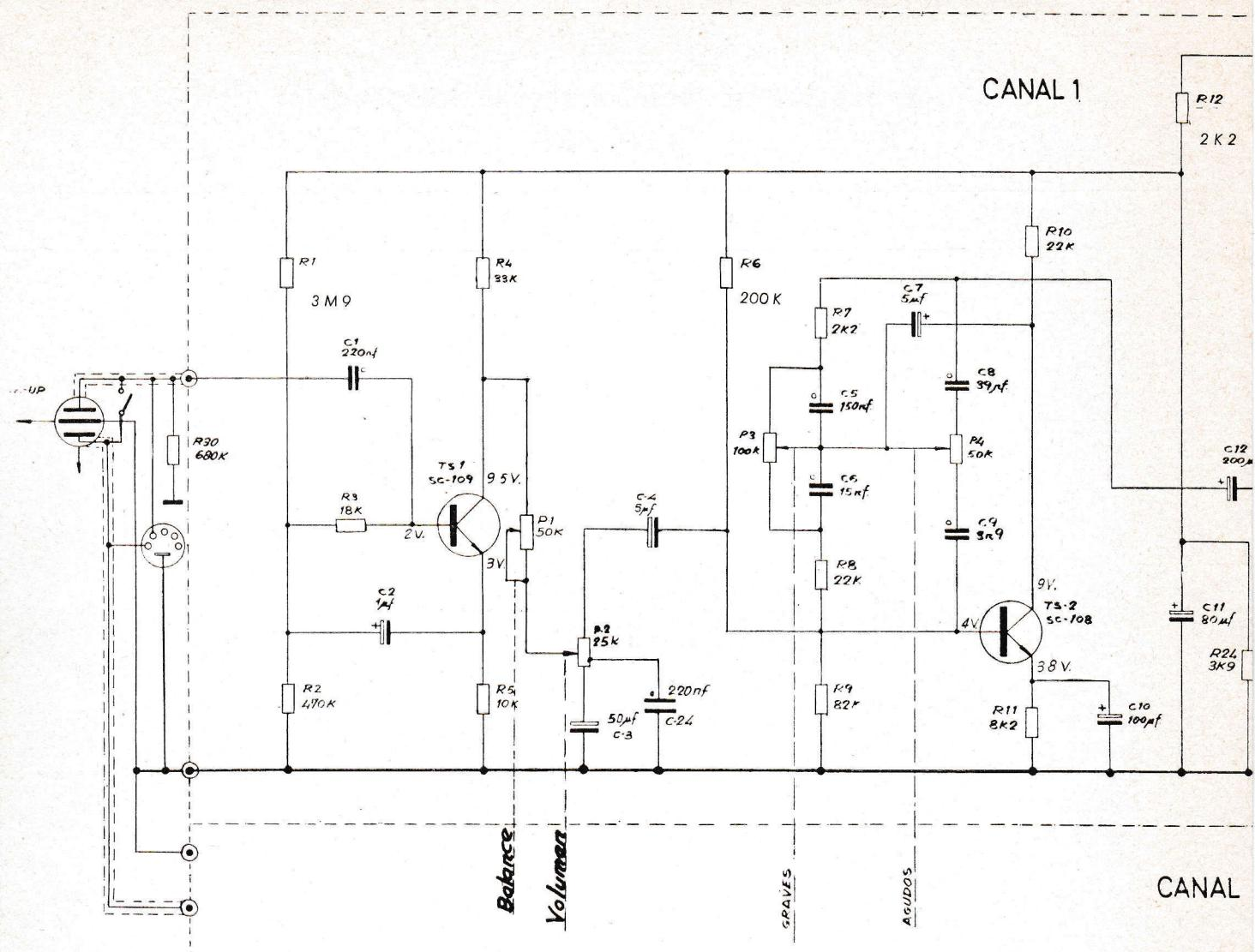
Nota Medidas realizadas con 125 V. de red con un voltímetro PHILIPS de 10.000 ohmios.
