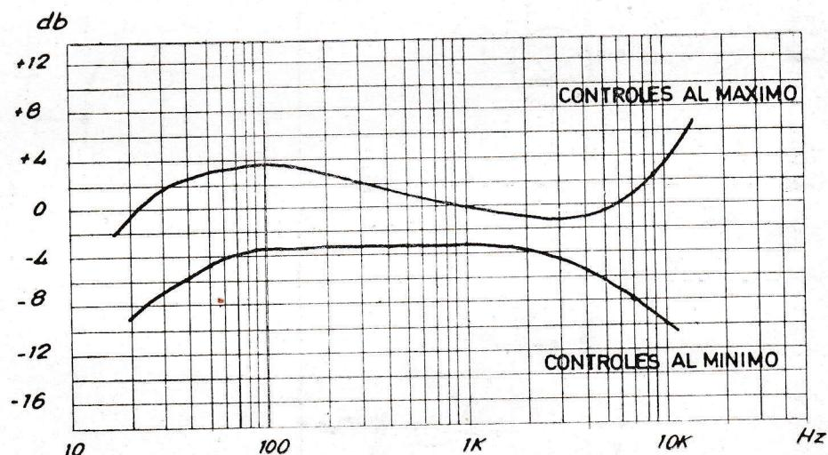
CURVA SACADA PARA UNA POTENCIA DE 50mW CON UNA SEÑAL DE ENTRADA DE 50 mV A LA FRECUENCIA CENTRAL DE 1000 c/s QUE CORRESPONDE A 0 db.
