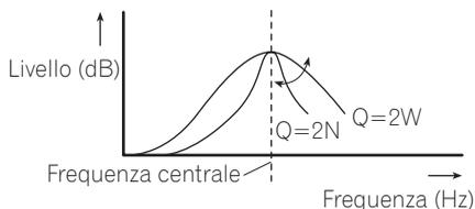
**1 Premere AUDIO e tenerlo premuto fino a quando sul display viene visualizzata la frequenza e il fattore Q (ad esempio, F- 80 Q 1W).**
