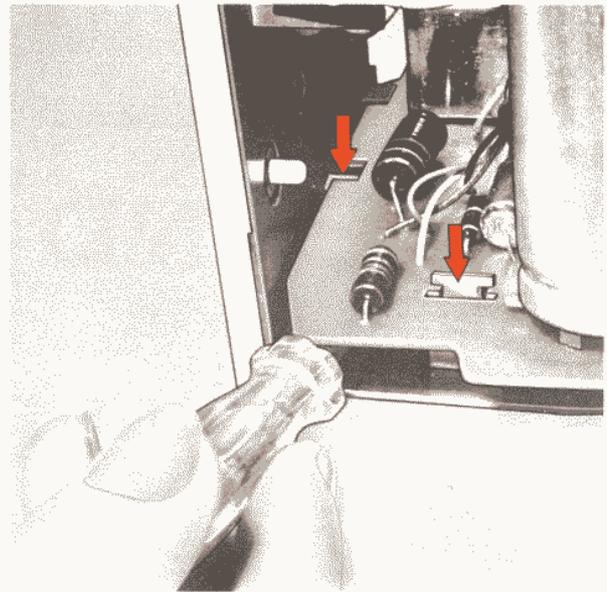
Abb. 5 Aushängen der Druckplatte
