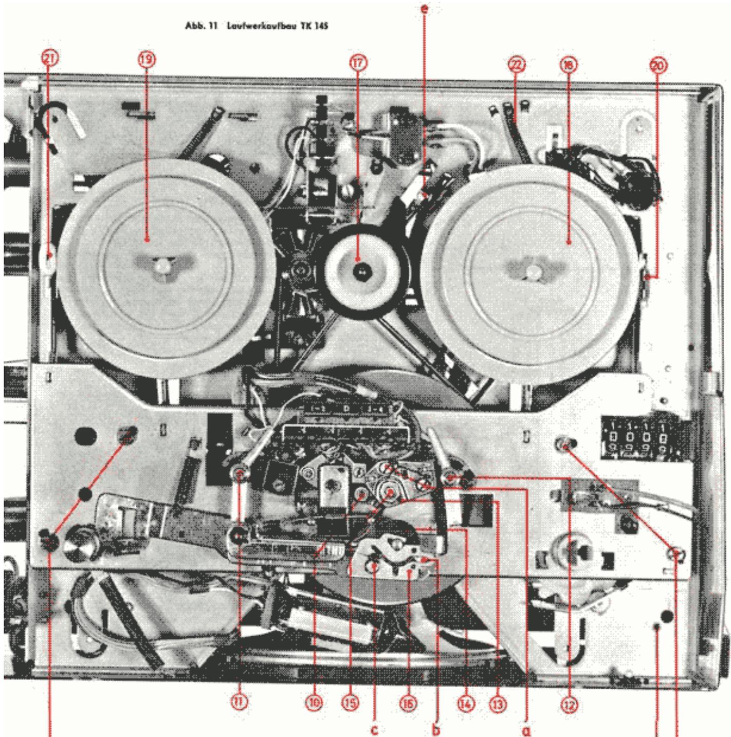
Befestigungspunkt der Antriebsteile bei U-Geräten und 60 Hz Umbau
