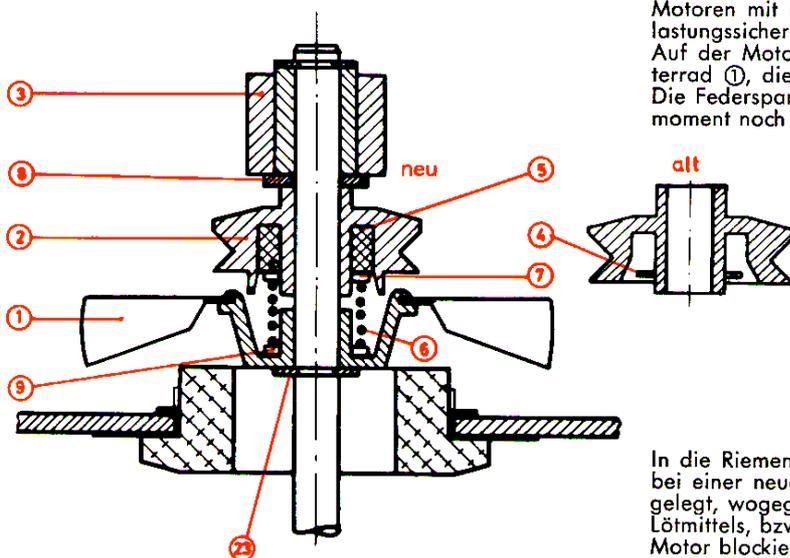
Abb. 10 Antrieb ohne Lüfter und Überlastungssicherung
