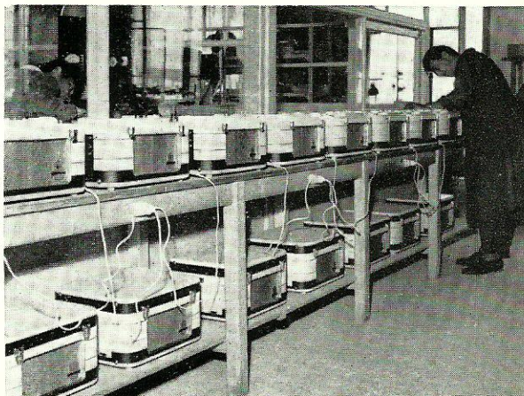
Avant l'envoi au stock (partie inférieure) les appareils subissent un dernier contrôle : audition de la bande témoin (partie supérieure).
