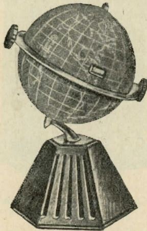
Le Radio-Globe. Un récepteur de T.S.F. dans une mappemonde.
