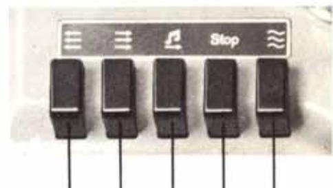
Ohne die Stoptaste zu betätigen kann aus Stellung Aufnahme oder Wiedergabe auf Schnelltransport vor- oder rückwärts, aus schnellem Vorlauf auf schnellem Rücklauf oder umgekehrt geschaltet werden. Dagegen ist die Taste "Wiedergabe" (10) gesperrt solange als eine der Schnelltransport-Tasten (8/9) benützt wird.
