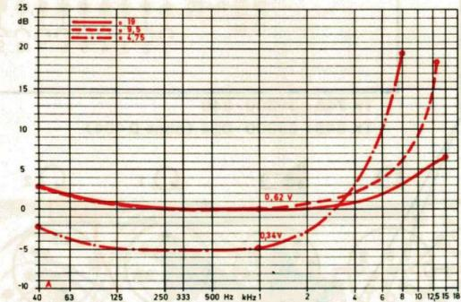
Abb. 17 Entzerrerkurve Aufnahme
