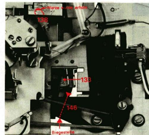
Abb. 21 Nachbiegen des Starthebels
