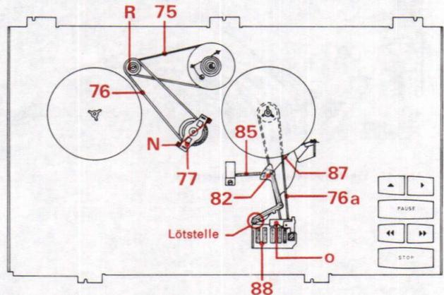
Abb. 9 Riemenwechsel
