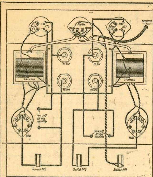
**MATERIEL NECESSAIRE POUR L'ALIMENTATION :** 1 châssis, 30 fr. ; 2 transfos, 100 fr. ; 4 condensateurs 12 MF, 600 v., 44 fr. ; 3 switch, 18,30 ; 1 plaquette répartiteur avec fusible, 2,50 ; 2 supports 4 broches améric. avec bouchons, 5 fr. ; 2 selfs 50 henrys 100 millis, 100 fr. ; 2 supports transeo, 3 fr. ; 1 cosse relais, 0,50 ; 1 cordon secteur, 3 fr. ; fil, vis, écrous, souples, 10 fr. ; 2 valves 1883, 48 fr. ; Câblage à façon (alimentation et émetteur), 350 fr.
