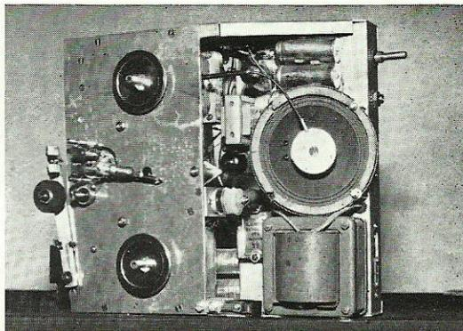
La qualité sonore est excellente pour une machine à dicter. Sa conception mécanique est parfaitement logique et le rebobinage dans les deux sens est extrêmement rapide grâce à ses trois moteurs. L'accessibilité des organes intérieurs tant mécaniques qu'électroniques est facile, ce qui rend le dépannage éventuel suffisamment aisé.
