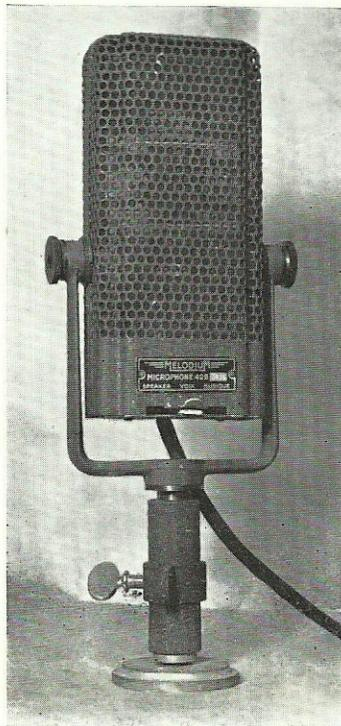
1° le microphone à cristal (ou piezo-électrique) ;
