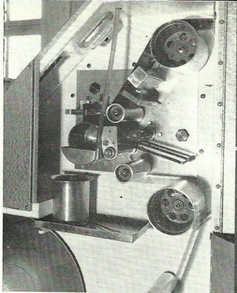
Couchage de l'émulsion et orientation de l'oxyde
