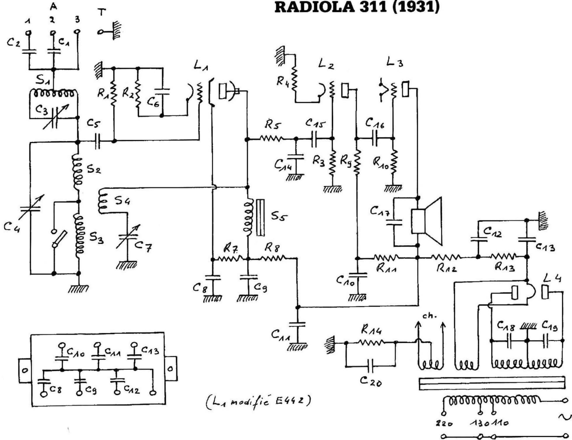
Le circuit bouchon  $S_1 - C_3$  couvre de 1 600 KHz à 500 KHz, on mettra  $C_3$  au maximum.
