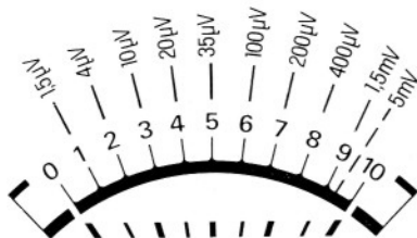
Die angegebenen Antennen-Eingangsspannungen sind ca. Werte
