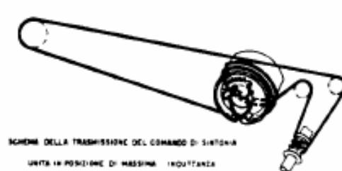
SCHEMA DELLA TRASMISSIONE DEL COMANDO DI SINTONIA
