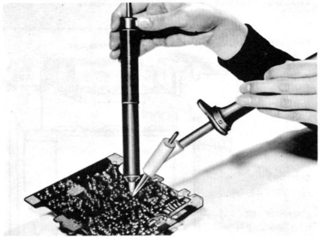
Remplacement des glissières de contact aux fins de réparation
