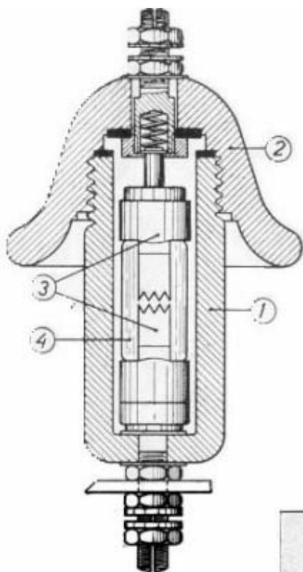
d'influences atmosphériques, telles qu'orages, pluie, neige ou grêle, avant qu'elles ne puissent produire de tensions dangereuses pour le sans-filiste, ou pour l'installation. Le limiteur de tension peut remplacer le commutateur antenne-terre. Il assure alors une protection tout à fait automatique.
