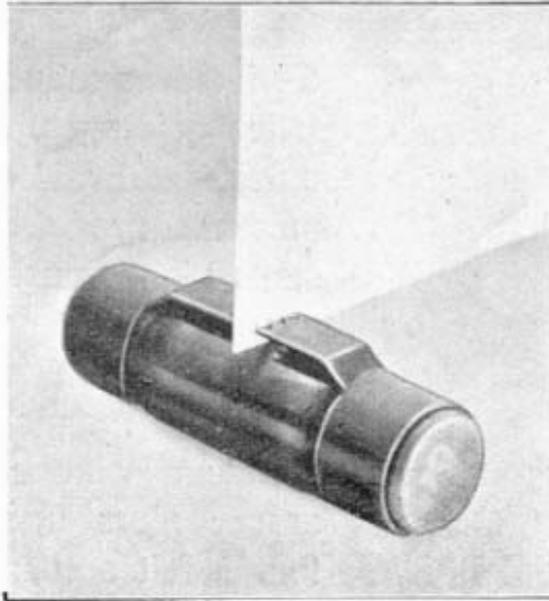
Régler cet éclateur en insérant entre ses dents une carte postale ordinaire que l'on retire ensuite. Pour plus de clarté la figure montre la manière d'effectuer ce réglage. Introduire la cartouche avec son éclateur dans le cylindre en verre. Mettre en place et fixer solidement la cloche protectrice.
