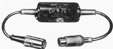
Questo apparecchio, collegato al registratore G 651 (al G 650 esso non è in alcun modo applicabile) serve a provocare la partenza del nastro quando un suono di conveniente intensità raggiunge il microfono, ed il suo arresto quando il suono sia cessato da qualche secondo.
