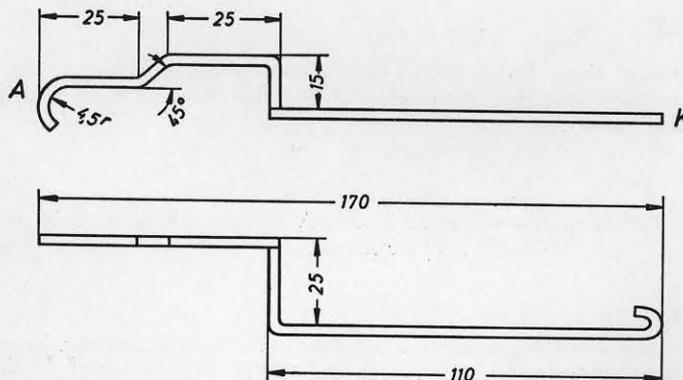
Der Haken wird mit der Rundung bei A in die Achse unter der Kupplung eingehängt. Die Federwaage wird bei K eingehängt.
