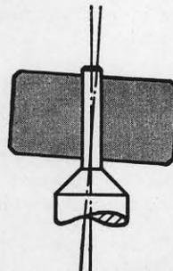
Nun wird der Führungsbolzen (Pos. 20) hochgeschraubt, bis der Bolzenbund das Band in erforderlicher Höhe führt. Anschließend wird der Führungsbolzen (Pos. 21) eingesetzt, daß der Bolzenkopf 0,05 mm Abstand von der Bandoberkante hat. Nach dem Einsetzen der Andruckklappe (Pos. 22) soll diese parallel zum Kopfspiegel stehen und der Filzandruck mit 30 g senkrecht auf den Kopfspalt drücken.
