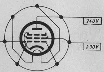
Spannungen bei Aufnahme, ohne Signal mit GRUNDIG RVM Typ 6062 ( $R_i = 30M\Omega$ ) gegen Chassis gemessen.
