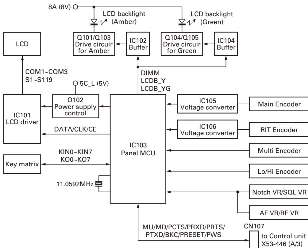
**Fig. 16 Display circuit**
