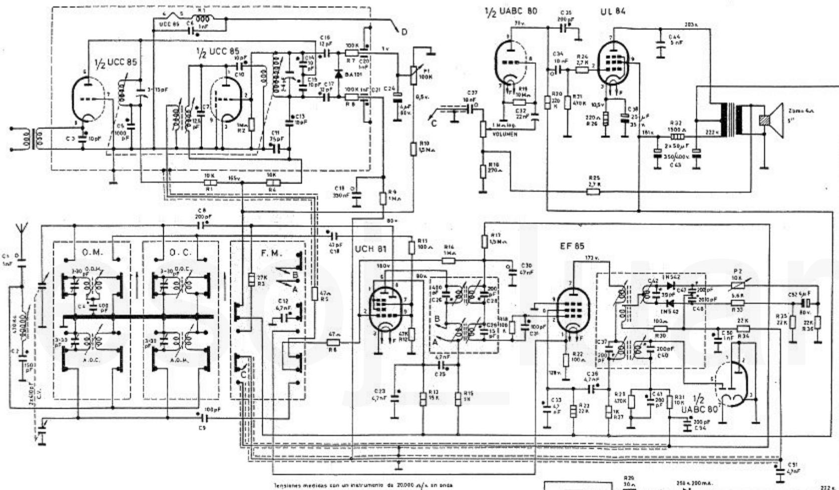
Tensiones medidas con un instrumento de 20.000 v/f.s. en onda media a 500 Kc, sin señal conectado a 125 K entradas.
